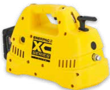
XC-Series, コードレス油圧ポンプ XC1201MB 2位置3方手動切換弁付き (単動油圧シリンダ用)
