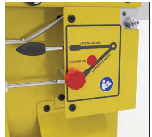
▲ キューブジャッキの昇降の安全ロックピン
