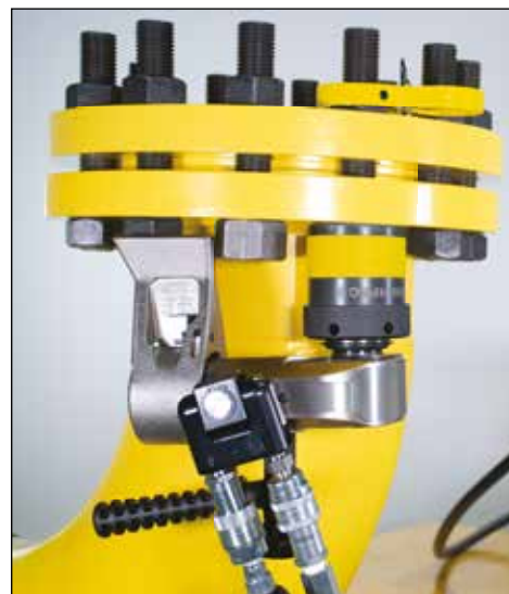
▲ SシリーズのトルクレンチとSTLLSトルクロック。レンチの四角ドライブとSafe Tトルクロックの交換は簡単です。
