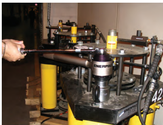
バー方式倍力レンチ(E393)を使用して、ボルトを手動で締めています。
