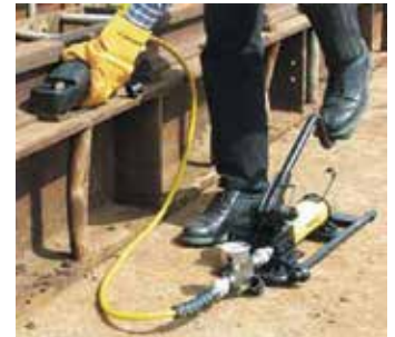
足の操作だけで簡単に扱える P392FP を使えば、油圧ツールやシリンダを両手で使用できます。
