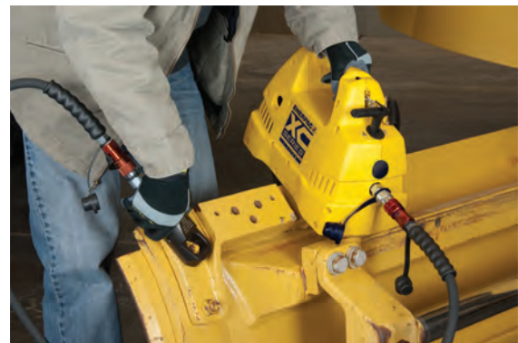
▲ XCシリーズポンプを使用して、油圧ナットカッタでナットを切断しています。
