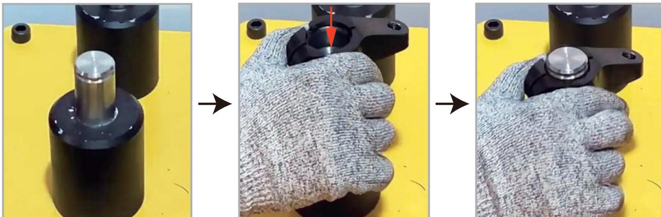
b. クリップをシリンダ溝に沿って取付けます。
