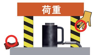
**警告**：シリンダの定格圧力を超える油圧ポンプを使用しないでください。シリンダの最大使用油圧は 70MPa です。シリンダの定格を超える圧力で使用したり、能力以上の重量の荷揚は絶対に行わないでください。過荷重はポンプやホースなどの装置の故障や場合によっては、人身事故の原因となります。
