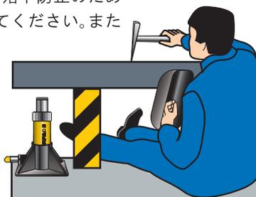
**警告：** シリンダは堅固で安定した土台(基盤)の上に固定して、転倒しないように適切に支持してください。また風などの外力による振動や衝撃ができるだけシリンダに伝わらないようにしてください。
