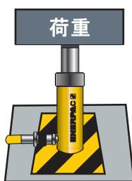
**警告：** シリンダへは斜め荷重や衝撃荷重を加えないでください。シリンダに対して水平の力が掛かるような場合は、転倒防止用のスタンドなどで確実にサポートをしてください。
