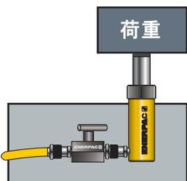
**警告：** 油圧機器を作動させる際に、作動油の汚染度に十分注意をしてください。荷重保持バルブなどが作動油中の異物により、その機能を損ない作動不良を起こす原因になることがあります。
