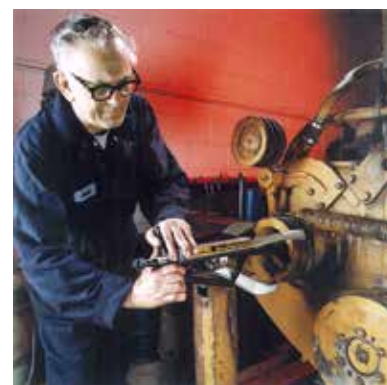
▲ EP-104 を使用してディーゼルエンジンからプーラーを引抜いています。
