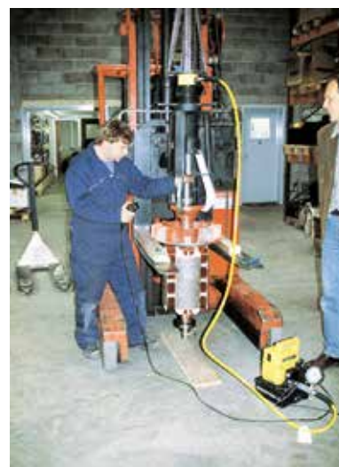
▲ モータ軸とカップリングを引抜く作業でリフトプレートに吊り帯を使用してプーラーの位置決めをしています。
