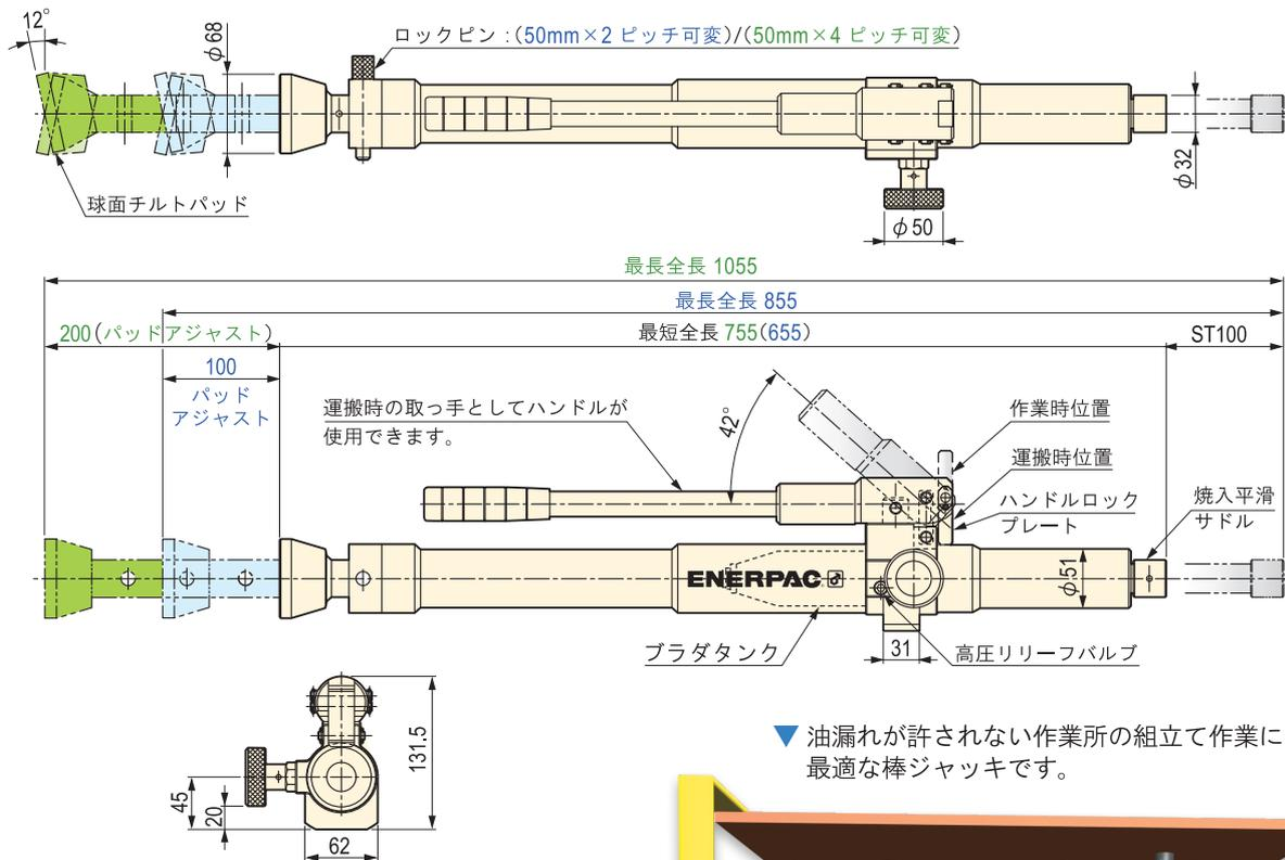
▼ 油漏れが許されない作業所の組立て作業に最適な棒ジャッキです。
