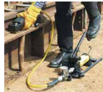
足の操作だけで簡単に扱える P392FP を使えば、油圧ツールやシリンダを両手で使用できます。
