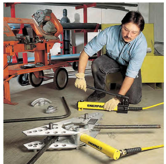
▲ STB-101H ベンダーセットを使用して、スチールパイプを素早く安全に 90° の角度まで曲げが可能です。
