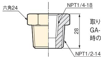
取り付けネジNPT1/4の圧力計をGA-1,GA-2,GA-11に取り付ける時のプッシングです。
