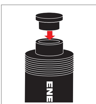
⚠ 注意：プランジャで直接ジャッキアップするときはキャップやサドルを使って、プランジャの端面とネジを保護してください。
