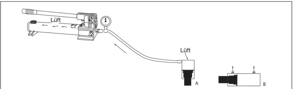
Alle Kupplungen von Hand vollkommen fest ziehen. Lose Kupplungsanschlüsse führen zur Einschränkung des Ölstromes zwischen der Pumpe und dem Zylinder.
