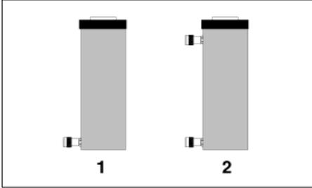
**IMPORTANTE:** Los cilindros de doble acción deberán tener ambos acopladores conectados.
