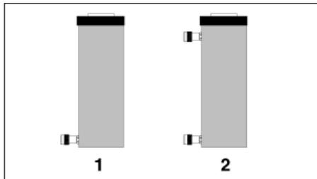
Bien serrer tous les raccords d'accouplement à la main. Des raccords mal serrés bloqueraient le flux d'huile entre la pompe et le vérin.
