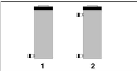
**WICHTIG:** Bei doppelwirkenden Zylindern müssen beide Kupplungen angeschlossen sein.
