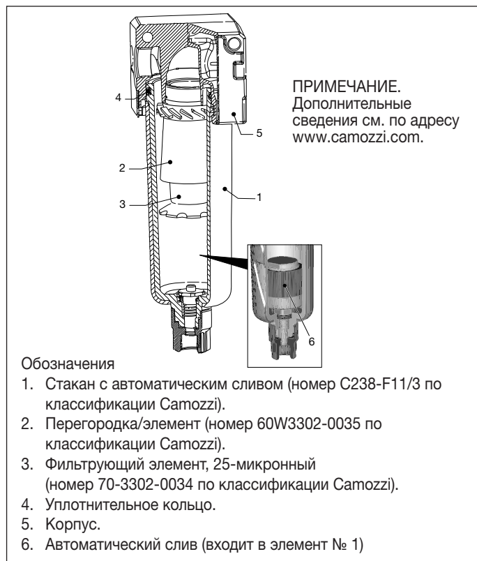
Рисунок 10 – детализация стакана воздушного фильтра
