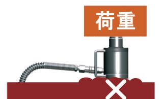
**危険**： 偏心荷重はシリンダとプランジャに相当なひずみを与えるので危険です。負荷を直接シリンダのプランジャ上のサドル全面で必ず受けるように設置してください。荷物が滑ったり落下したりして、危険な状況を引き起こす原因になります。
