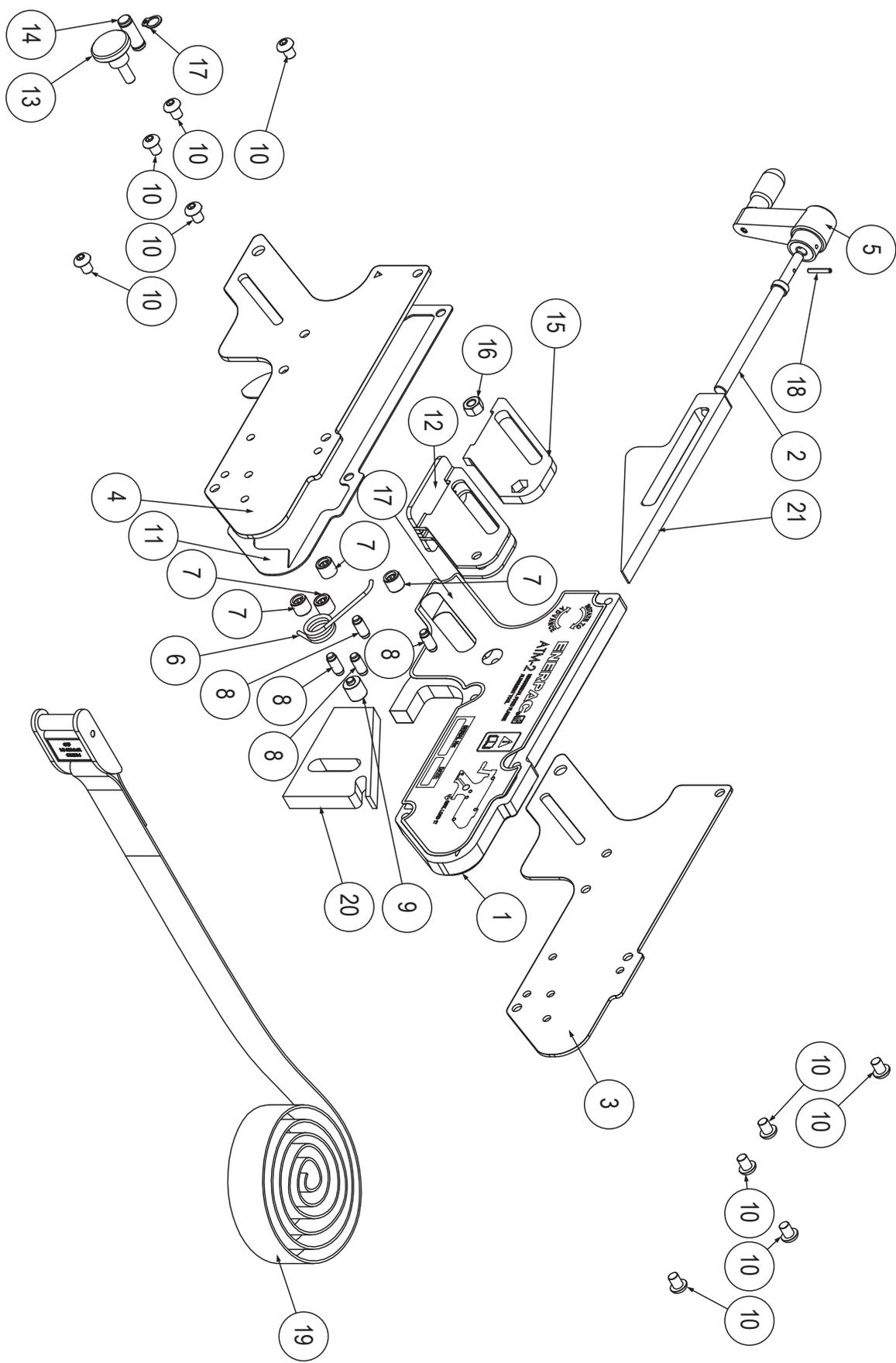
図-1 ATM-2 フランジアライメント工具
